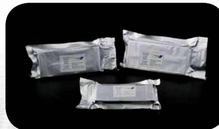
Lamínula para microscopia, com espessura de 0,13 a 0,16 mm. Embaladas a vácuo em papel aluminizado.
